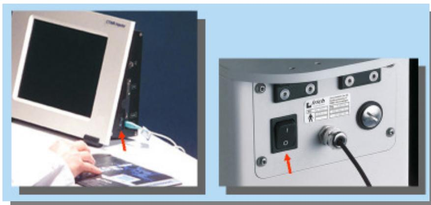
Рис. 6-1 Сетевой выключатель на терминале и инжекторе
